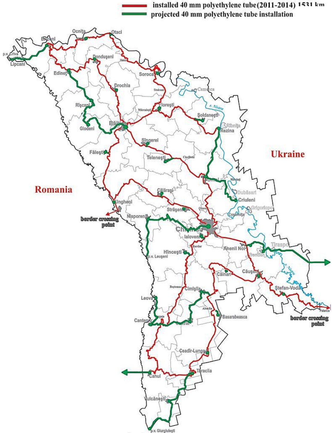
Fig. 3. Rețeaua Națională de Fibră Optică “e-Dome”
